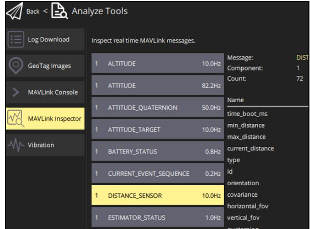
Figure 135 MAVLink DISTANCE\_SENSOR message
